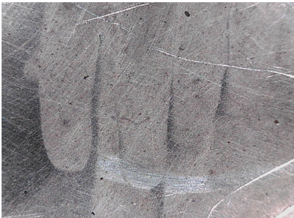
Imagen 3 - Líneas finas del pulido de la placa de metal y erosiones en superficie con pérdida de imagen. Microscopía óptica digital_60x
